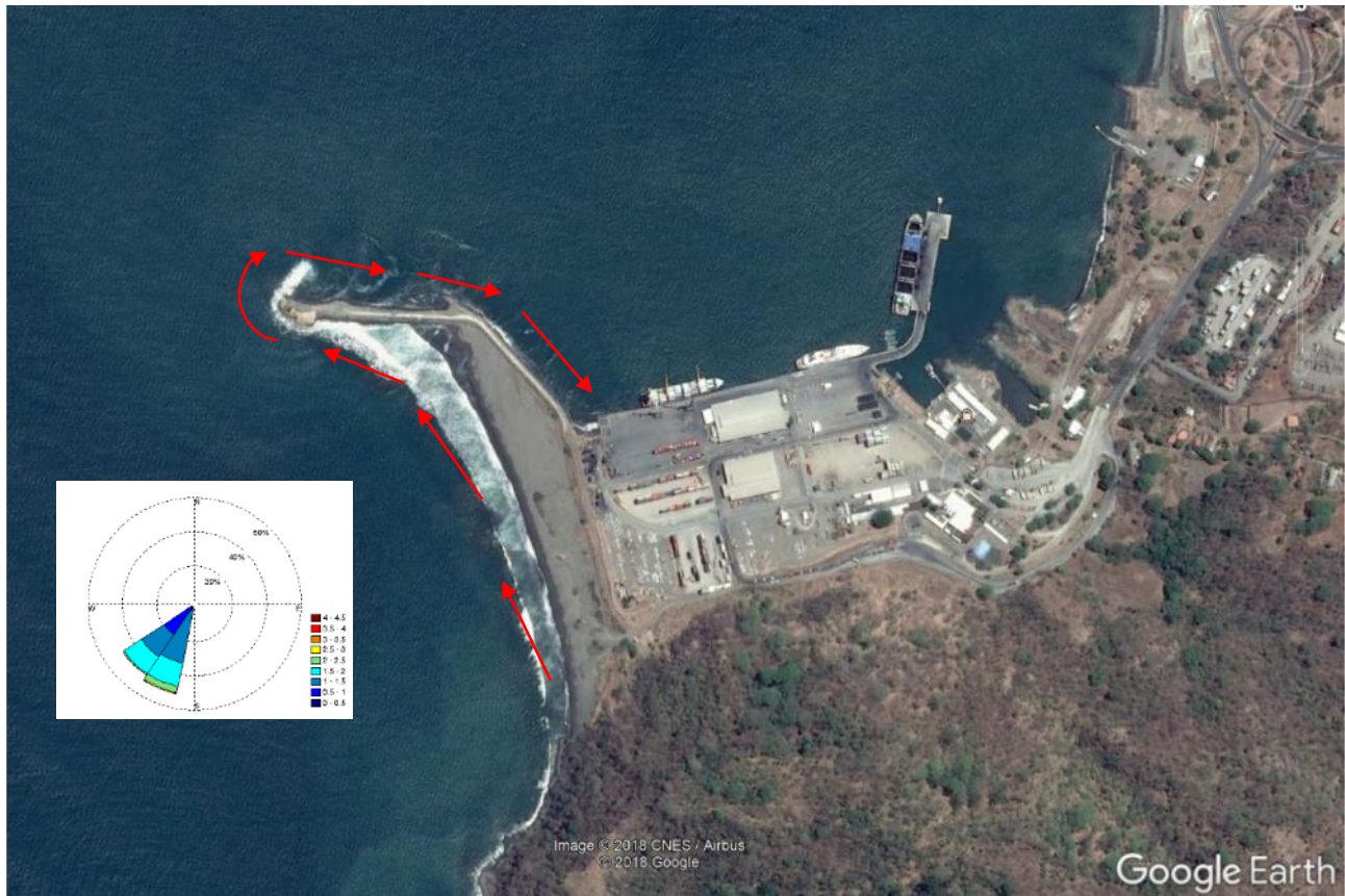
Figura 2-7 Vía de sedimentos, causando sedimentación en el borde del rompeolas (fondo: imagen de Google Earth de abril de 2016)
